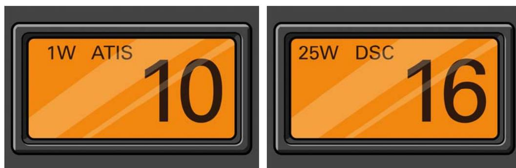
*Abbildung: links: Eine auf den Binnenschiffahrtfunk Kanal 10 eingestellte Funkanlage, rechts: Eine auf Seefunk Kanal 16 eingestellte Funkanlage*
